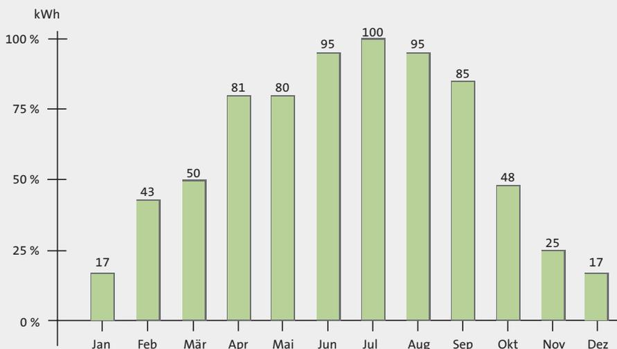
Übers Jahr gesehen, lassen sich bei einem Einfamilienhaus bis zu 60% des benötigten Warmwasserbedarfs mit einer Solaranlage von BRÖTJE abdecken. Hierfür reicht bereits eine Kollektorfläche von 4 m<sup>2</sup> bis 6 m<sup>2</sup> aus.
